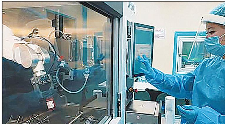
ной системе в онкоцентре также используются ламинарные боксы BiOptima IT II класса безопасности, интегрированные с платформой KiroLink и системой Kiro Assist. Эти технологии позволяют осуществлять ручное приготовление препаратов в условиях постоянного контроля, включая верификацию компонентов, контроль массы и документирование всех этапов работы.
